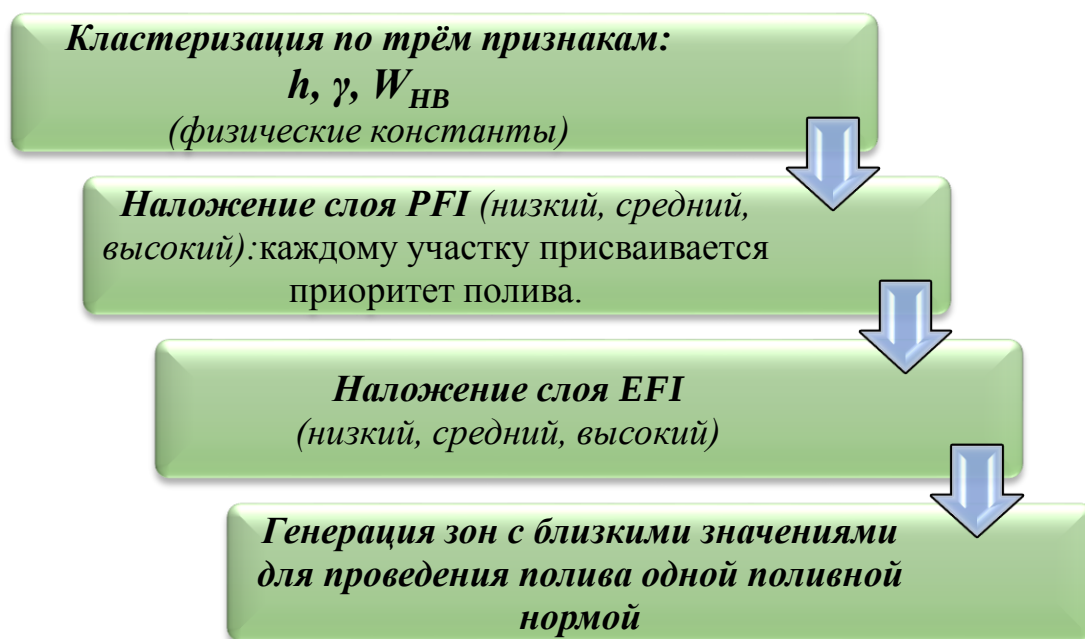
Рисунок 2.10 – Алгоритм зонирования поля
