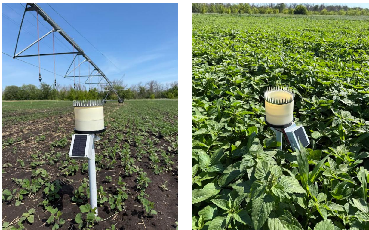
Рисунок 3.5 – Датчики влажности и температуры почв фирмы Kaipos на орошаемом поле УНПО «Поволжье»
