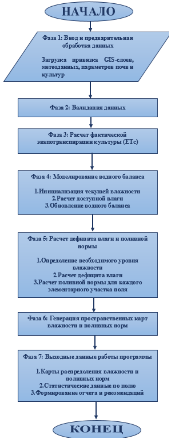
Рисунок 4.14 – Алгоритм работы программы пространственного распределения поливных норм по площади орошаемого поля
